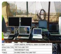
⑨양방향 재하시험(자동화 계측)
